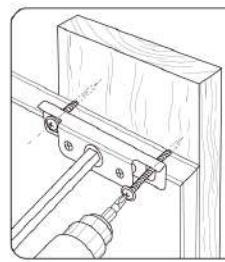
Fixez les vis (incluses) avec le support dans le mur à l'endroit où il y a un montant.
