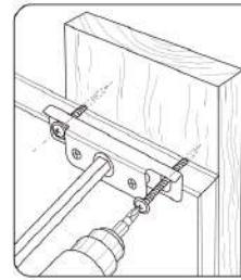
Monta los tornillos (incluidos) con el soporte en la pared donde hay un montante
