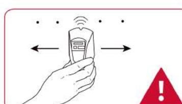
03 Déterminez s'il y a des montants derrière le mur à l'endroit où vous voulez monter le support.
