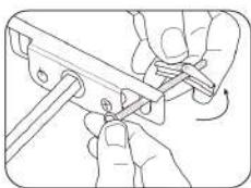
La partie ouverte des ailes doit être orientée vers la tête du boulon.
