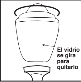
Figure 7 Conjunto de vidrio atornillado
