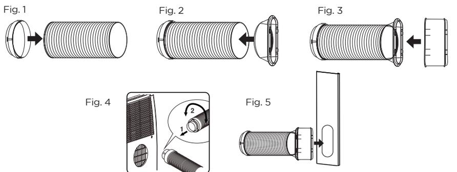
**REMARQUE:** Le tuyau d'échappement peut être comprimé ou étendu modérément, mais il est souhaitable de garder la longueur au minimum. Assurez-vous également que le tuyau n'a pas de coudes serrés.
