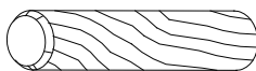
B ø8 x 30mm Wood Dowel de la cheville en bois la espiga de madera x16
