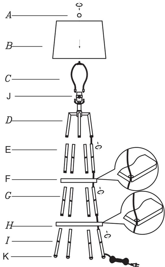
**NOTA:** Si el piso no está bien nivelado, gire las almohadillas de las patas (K) para estabilizar la lámpara.
