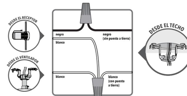
**!** Gire los empalmes hacia arriba y presiónelos cuidadosamente hacia atrás a través del soporte de suspensión dentro de la caja de salida. Separe los alambres, con los alambres puestos a tierra a un lado de la caja de salida y los alambres no puestos a tierra al otro lado de la caja de salida.
