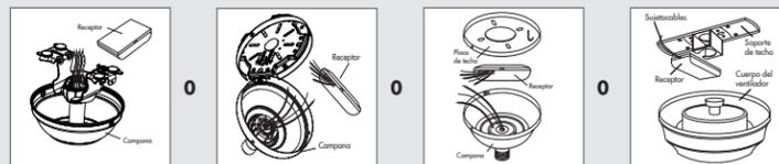
**Nota:** Algunos ventiladores pueden tener un exceso considerable de cable conductor. Para una instalación más fácil de la campana, recorte el cable y deje un mínimo de 8" (20 cm.) Pele 1/2" (1 cm) de los cables conductores del ventilador. Coloque el resto del cable sobrante en la caja eléctrica de techo. **El soporte y el ventilador deben conservar una puesta a tierra adecuada.**
