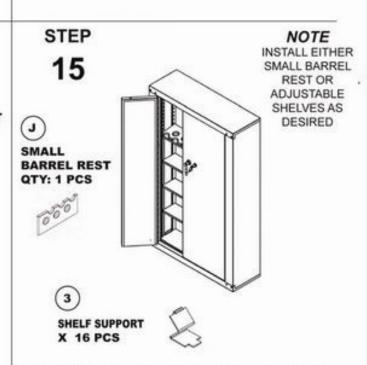
INSERT METAL STORAGE SHELVES OR SMALL BARREL REST ON THE SMALL LEFT SIDE OF THE CABINET USING SHELF SUPPORTS IN THE DESIRED LOCATION.
