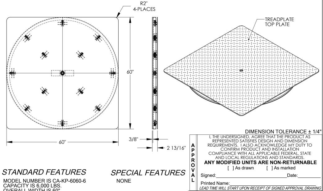
**OVERALL WIDTH IS 60" OVERALL LENGTH IS 60" OVERALL HEIGHT IS 2 13/16"** SQUARE TOP TREADPLATE WITH ROUNDED CORNERS DURABLE LIQUID PAINT YELLOW FINISH
