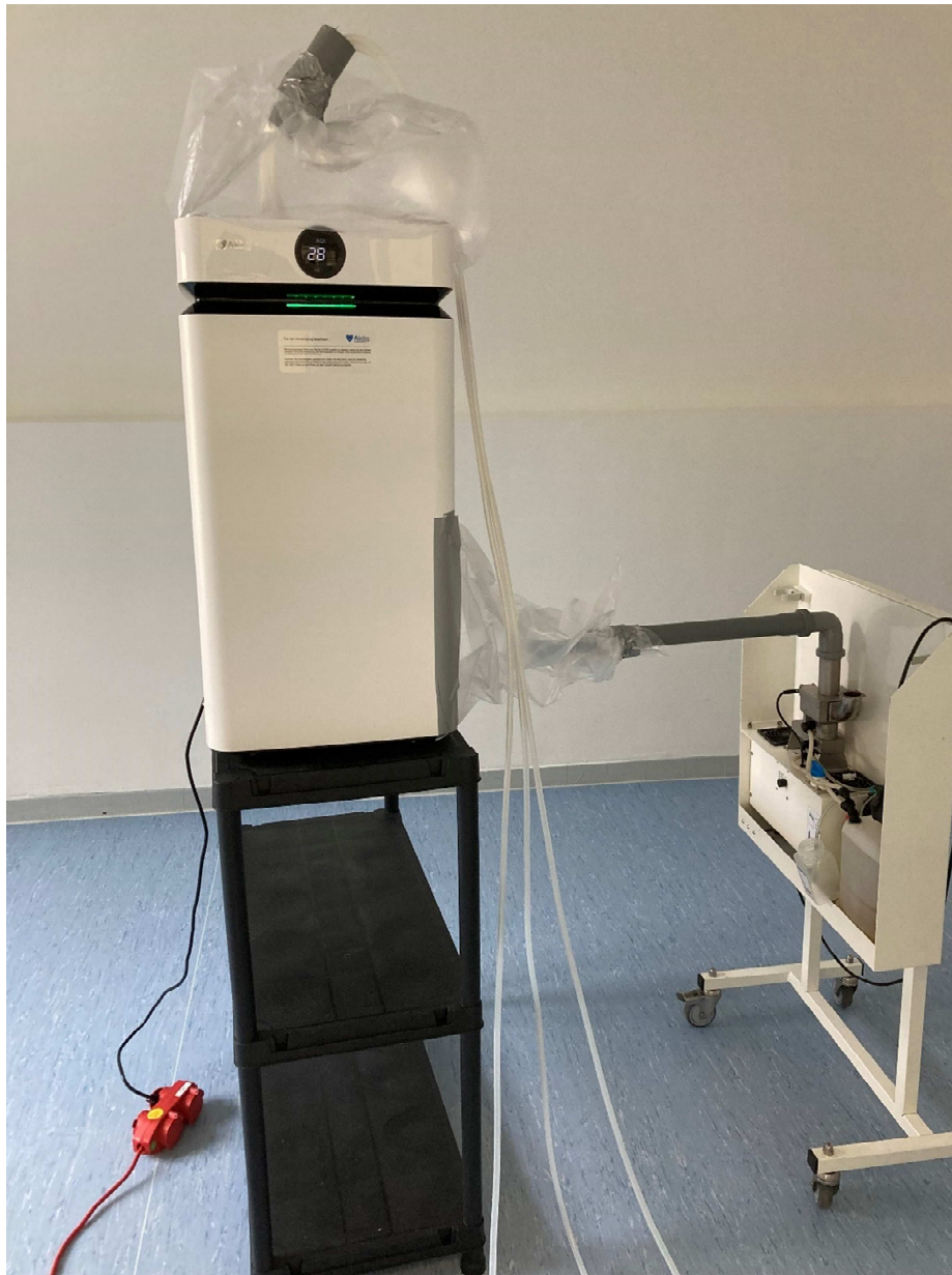
Abb. 6 / fig. 6: Prüfprodukt während der Vernebelungsphase (Prüfprodukt links, Einlass und Auslassseite durch Kunststoffolie getrennt; rechte Seite Präzisionsvernebler verbunden mit der Einlassseite des Airdog X8; S/N: BAKGF88A043056 / Test product during the nebulization phase (test product on the left, inlet and outlet side separated by plastic film; right side precision nebulizer connected to the inlet side of the Airdog X8; S/N: BAKGF88A043056
