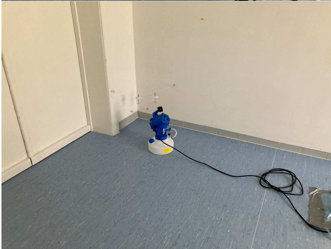
Abb. 7 / fig. 7: Präzisionsvernebler Typ Typhoon zur Ausbringung des Aerosols / precision nebulizer type Typhoon for fogging of the aerosols
