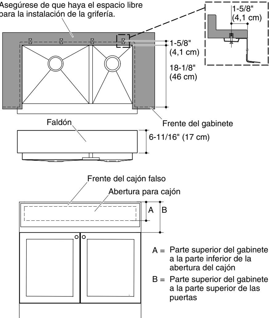
**¡IMPORTANTE!** Antes de instalar este fregadero, verifique que la altura de la abertura (A) sea menor que la altura del faldón y que la distancia a la parte superior de las puertas (B) sea mayor que la altura del faldón.
