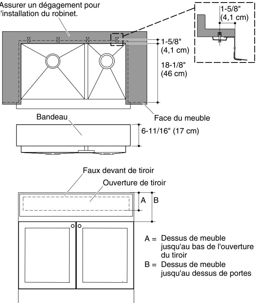
**IMPORTANT!** Avant d'installer cet évier, vérifier que la hauteur de l'ouverture (A) est inférieure à la hauteur du bandeau et que la distance jusqu'au dessus des portes (B) est supérieure à la hauteur du bandeau.
