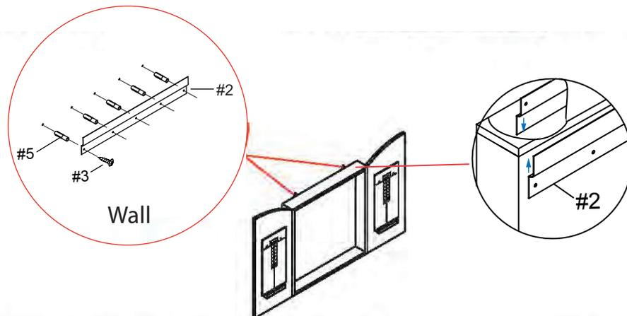
Étape 2: Sélectionnez une mèche qui est à peu près du même diamètre que les chevilles d'ancrage (n° 5). Une fois les trous percés, utilisez un marteau pour insérer les chevilles d'ancrage (n° 5) dans les trous. Une fois les chevilles d'ancrage (n° 5) insérées, vissez les vis (n° 3).
