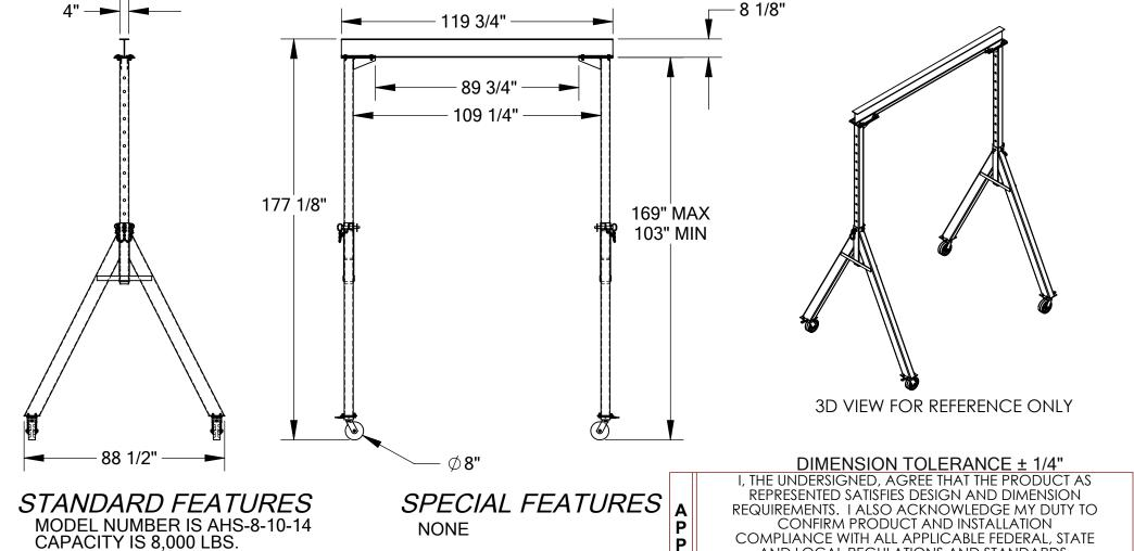
CAPACITY IS 8,000 LBS. BASE WIDTH IS 88 1/2" MAX OVERALL HEIGHT IS 177 1/8" I-BEAM HEIGHT IS 8 1/8" I-BEAM FLANGE WIDTH IS 4" OVERALL I-BEAM LENGTH IS 119 3/4" USABLE I-BEAM LENGTH IS 89 3/4" ADJUSTABLE UNDER I-BEAM HEIGHT 169" MAX 103" MIN HEIGHT IS ADJUSTABLE IN 6" INCREMENTS CASTERS: (4) Ø8" X 3" WIDE PHENOLIC
