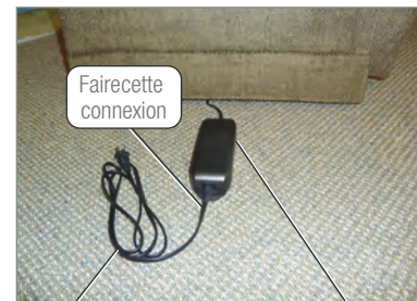
Cordon électrique de 120 volts Transformateur électrique
