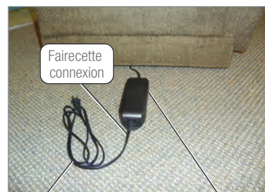
Cordon électrique de 120 volts Transformateur électrique
