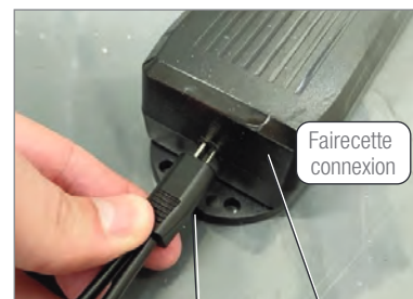
Câble en Y Transformateur électrique
