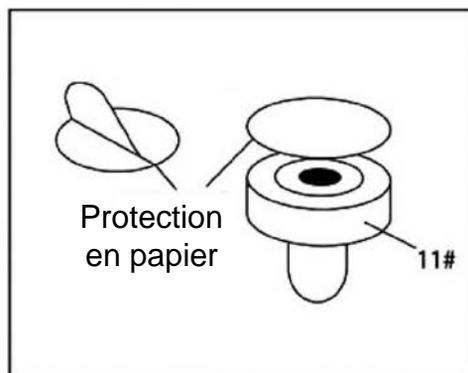
Retirer la pellicule de protection en papier des pastilles de feutre et les coller à la face inférieure des poussoirs (N° 11).
