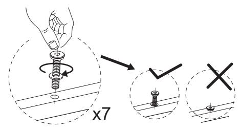
NOTE: DO NOT TIGHTEN THE SCREWS COMPLETELY.
