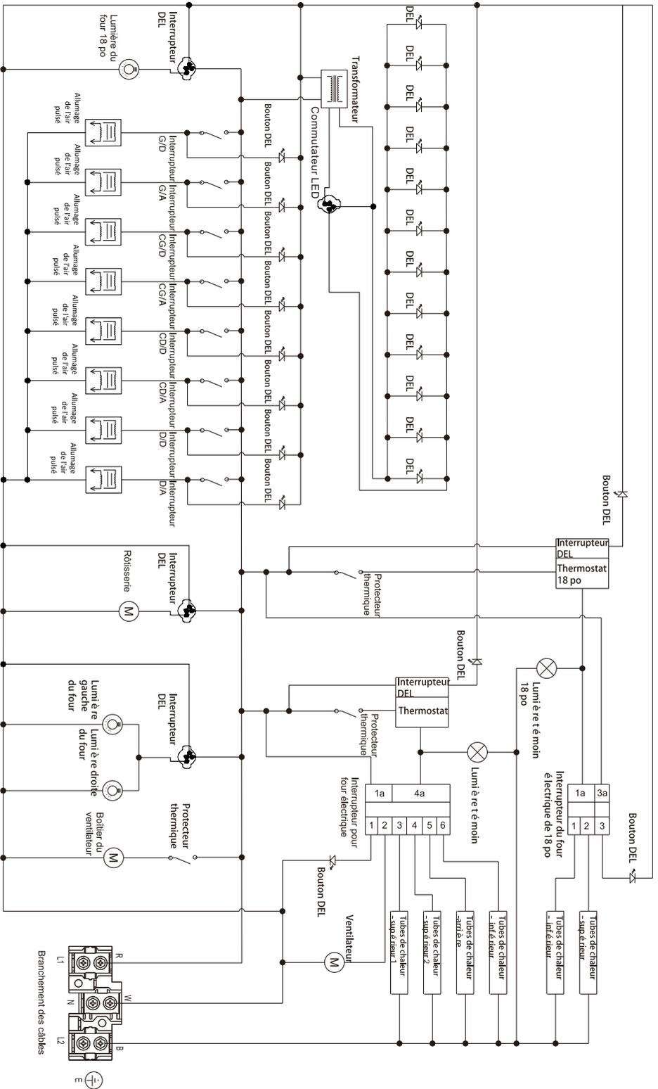
**Mise en garde :** Marquez tous les fils avant de les débrancher lors de l'entretien des commandes. Les erreurs de câblage peuvent entraîner un dysfonctionnement et des dangers. Vérifiez le bon fonctionnement après l'entretien.
