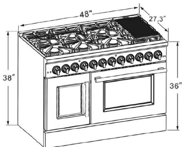
Cette cuisinière peut être installée directement à côté des armoires existantes à une hauteur de comptoir (36 po ou 91,5 cm du sol). Pour obtenir le meilleur aspect possible, la table de cuisson doit être au même niveau que le comptoir de l'armoire. Cela peut être obtenu en soulevant l'unité à l'aide des tiges de réglage sur les pieds.
