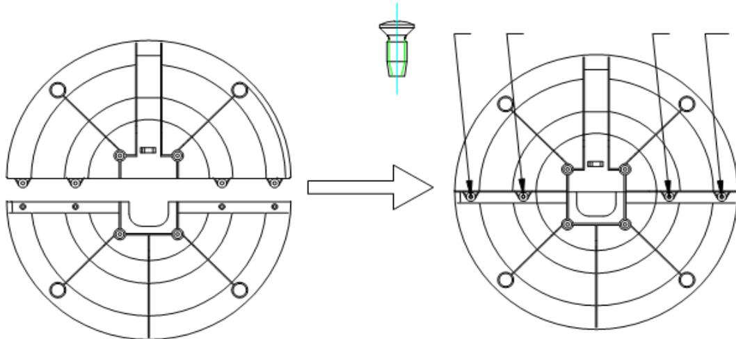
3. Faites passer le cordon d'alimentation à travers le socle, et insérez le socle avec quatre vis dans le corps principal du produit.
