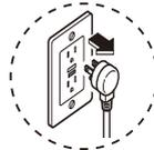
Si l'alimentation est débranchée, l'appareil peut mal fonctionner ou provoquer une défaillance ou une décharge électrique.
