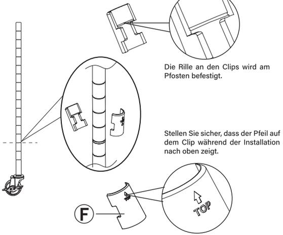
Die Rille an den Clips wird am Pfosten befestigt.
