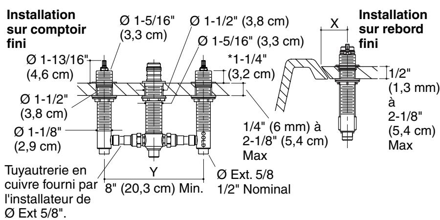
\*La dimension permet un réglage de +/-1/4" (6 mm) de la poignée durant l'installation de la garniture de poignée.
