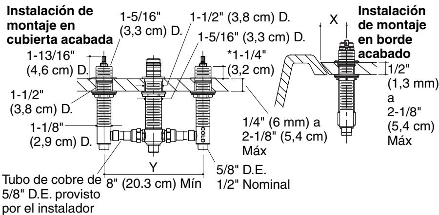
\*La dimensión permite un ajuste de manija de +/-1/4" (6 mm) durante la instalación de la garnición de la manija.
