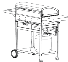
Le dispositif de fixation de la bonbonne est verrouillé dans le sens des aiguilles d'une montre
