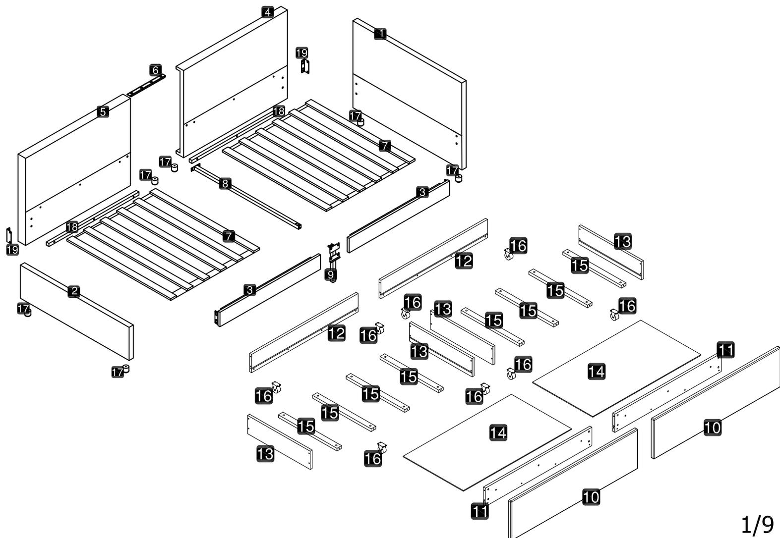
DE:Vor dem Einbau die Schrauben in die Löcher stecken und festziehen, aber nicht bis 100%, 70% bis 80% anziehen reicht aus. Schließlich, nachdem alle Schrauben installiert sind, ziehen Sie alle Schrauben auf 100%.Wenn Sie auf diese Probleme stoßen, wie z. B. Fehlausrichtung der Löcher oder Unfähigkeit, bestimmte Teile zu installieren, überprüfen Sie bitte, ob die Schrauben korrekt verwendet werden und passen Sie die Dichtigkeit der Schrauben an.
