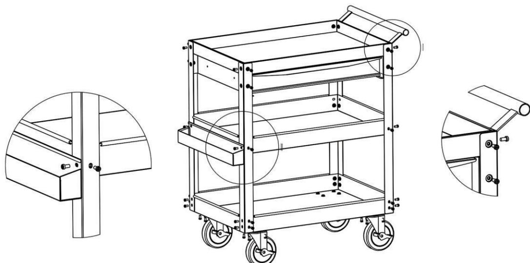
En utilisant quatre boulons de carrosserie, quatre rondelles pour roulettes et quatre écrous hexagonaux pour roulettes, fixez la roulette pivotante au coin suivant de la tablette inférieure et suivez les mêmes directions pour la roulette pivotante finale. (figure 1)
