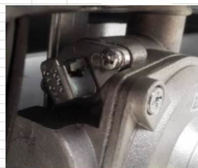
Fig. 11b: Válvula de cierre cerrada
