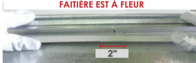
ÉTAPE 3 : RETOURNEZ LA FONTIÈRE ET MESUREZ 9 27/32" DE L'EXTRÉMITÉ DE CHAQUE FAITIÈRE. PLACEZ LES VIS TEK PAR INCRÉMENT DE 2" À PARTIR DE DITE EXTRÉMITÉ. RÉPÉTEZ CE PROCESSUS POUR LA MOITIÉ OPPOSÉE DE LA POUTRE FAITIÈRE
