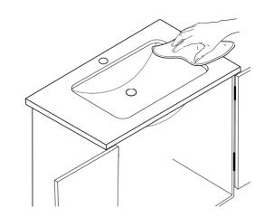
Essuyez l'excès de mastic silicone avec un chiffon humide. Raccordez l'évacuation et l'alimentation en eau conformément aux instructions du fabricant.
