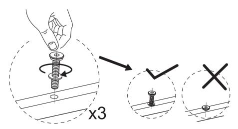
NOTE: DO NOT TIGHTEN THE SCREWS COMPLETELY.
