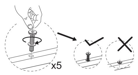
NOTE: DO NOT TIGHTEN THE SCREWS COMPLETELY.
