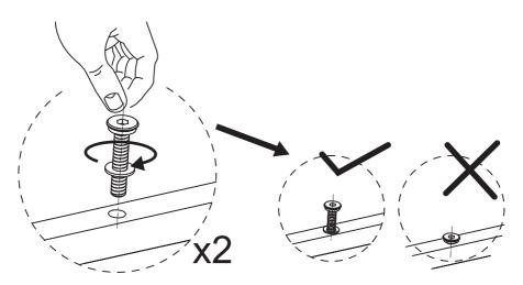
NOTE: DO NOT TIGHTEN THE SCREWS COMPLETELY.
