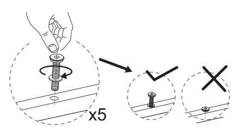
NOTE: DO NOT TIGHTEN THE SCREWS COMPLETELY.
