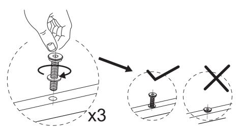
NOTE: DO NOT TIGHTEN THE SCREWS COMPLETELY.
