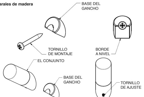
Coloque el conjunto del gancho sobre la base. Acople el gancho a la base con el tornillo de fijación.
