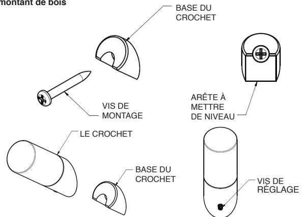
Placez le crochet sur la base. Fixez le crochet sur sa base à l'aide d'une vis de réglage.
