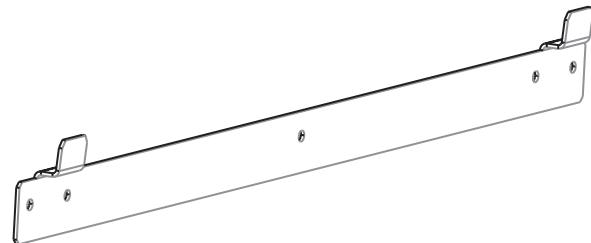
Fije la abrazadera de soporte, al menos con 5 tornillos, horizontalmente a la pared; utilice las fijaciones apropiadas para el tipo de pared. Téngase en cuenta que la unidad pesa aproximadamente 55lb.
