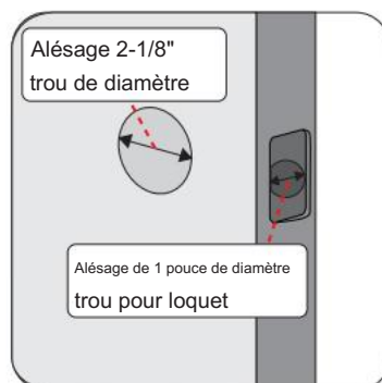
Mesurer le diamètre du 2 trous
