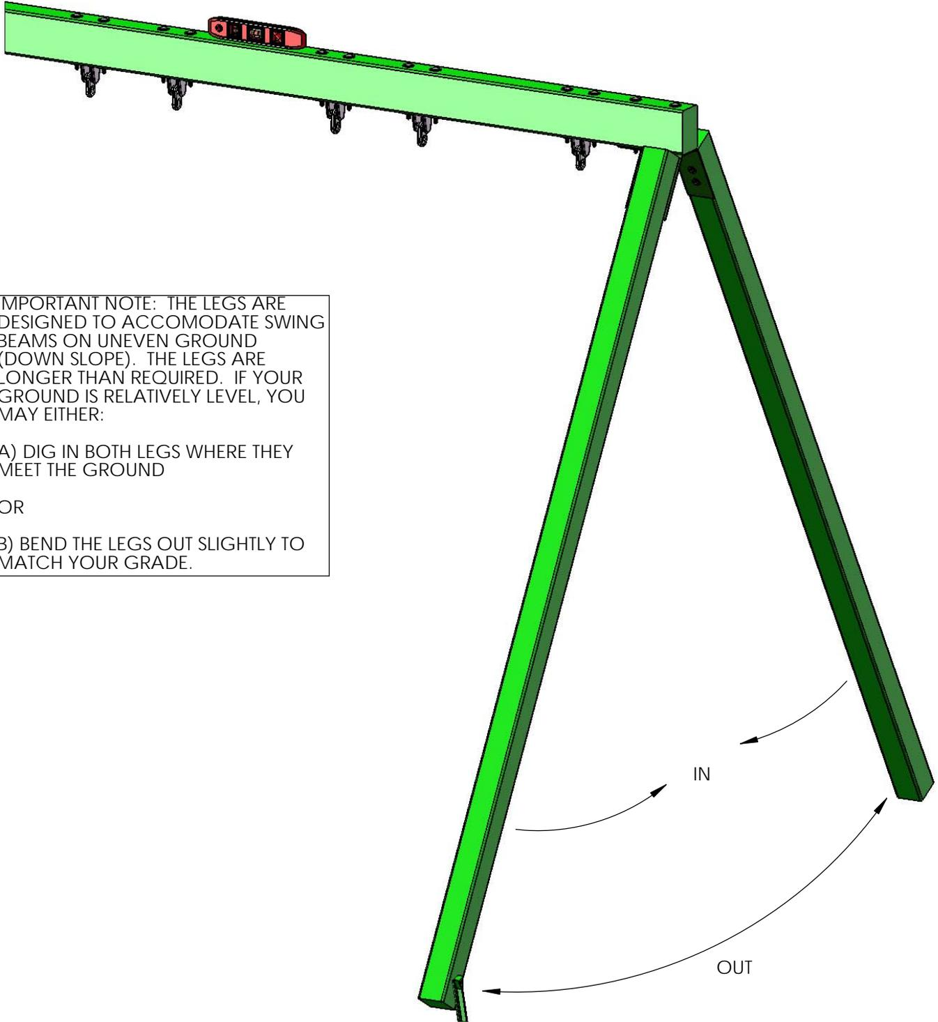
IMPORTANT NOTE: THE LEGS ARE DESIGNED TO ACCOMODATE SWING BEAMS ON UNEVEN GROUND (DOWN SLOPE). THE LEGS ARE LONGER THAN REQUIRED. IF YOUR GROUND IS RELATIVELY LEVEL, YOU MAY EITHER:
