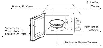
REMARQUE: Ne retirez pas la plaque de mica qui recouvre le guide d'ondes dans la cavité du four.
