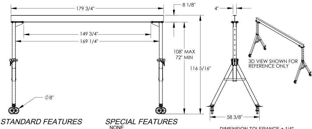
**MODEL NUMBER IS AHS-4-15-9** CAPACITY IS 4.000 LBS. BASE WIDTH IS 58 3/8" MAX OVERALL HEIGHT IS 116 5/16" I-BEAM HEIGHT IS 8 1/8" I-BEAM FLANGE WIDTH IS 4" OVERALL I-BEAM LENGTH IS 179 3/4" USABLE I-BEAM LENGTH IS 149 3/4" ADJUSTABLE UNDER I-BEAM HEIGHT 108" MAX
