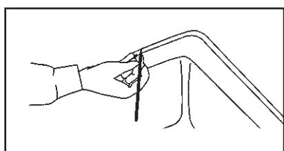
1. Coloque el fregadero boca abajo en la superficie de la encimera. Tenga en cuenta el espacio adecuado para el grifo, el respaldo y cualquier accesorio, como un dispensador de jabón / loción. Coloque el fregadero en la posición exacta para la instalación y con un lápiz dibuje una línea completamente alrededor del fregadero para que el fregadero se adapte perfectamente.
