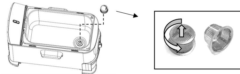
A l'aide d'un tournevis ou de votre doigt, poussez la vis située sous le récipient d'huile propre. Cela permettra au système de filtration de s'ouvrir.
