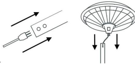
5. Assurez-vous de le tirer doucement à travers du tube le plus possible. Fixez ensuite le cordon d'alimentation dessous la base avec les deux vis et crochet fournis.
