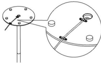
6. Insérez le radiateur dans le tube du haut puis vissez-le en place avec les deux vis 2 X M4\*8 fournies.
