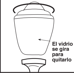
Figure 7 Conjunto de vidrio atornillado
