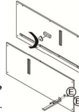
2. Verschrauben Sie die Seitenwände mit den beiden Vorderteilen und den beiden Teilen der Rückwand.
