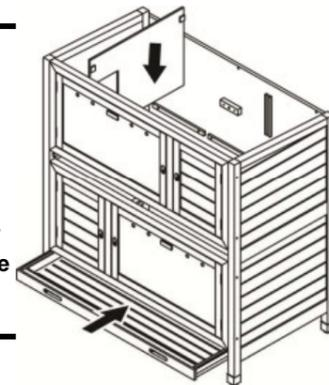
4. Setzen Sie die hintere Bodenplatte und die obere Bodenwanne ein.
