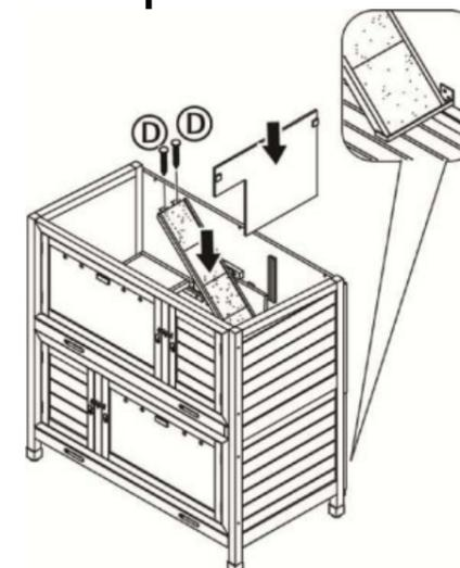
7. Befestigen Sie das Dach und das Fangband.
