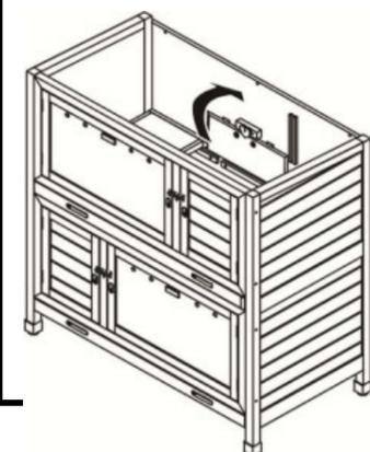
6. Schieben Sie die Rampe durch die Öffnung und schrauben Sie diese so fest, dass der Fuß der Rampe in der Metallfixierung steht. Setzen Sie die obere Trennwand ein.
