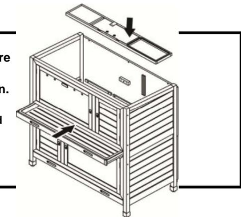
5. Öffnen Sie die Klappe des Mittelbodens und befestigen Sie diese mit dem Herzverschluss.
