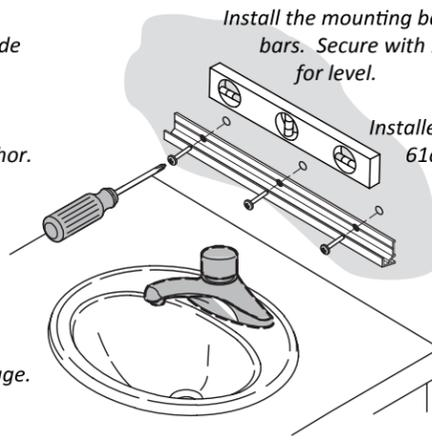
Installer la barre de fixation. Pour les armoires 61cm utiliser 2 barres de montage. Fixez avec 1 1/2" vis et des chevilles. Vérifier à nouveau le niveau.
