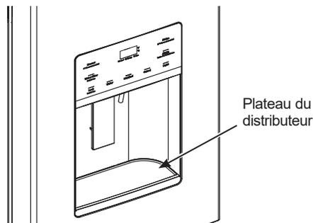
Appuyez le verre délicatement contre le berceau du distributeur. La tablette antidébordement ne se draine pas automatiquement. Pour réduire les taches d'eau, elle doit être nettoyée régulièrement.
