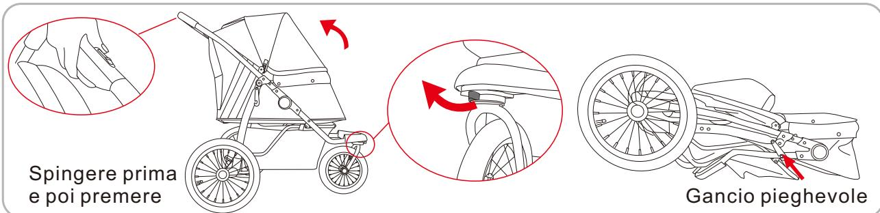
2. Telaio pieghevole In stato di frenata, rilasciare la cerniera e ripiegare la capote; rilasciare la funzione di orientamento della ruota anteriore; tenere il manubrio con una mano, spingere il pulsante di sblocco sul manubrio a sinistra, quindi premere il pulsante di chiusura e premere il telaio, il telaio può essere ripiegato, infine appendere il gancio.
