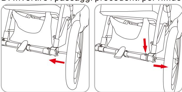
4. Installare e smontare le ruote posteriori
