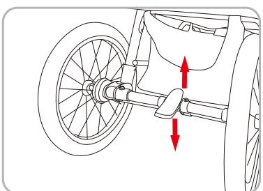
5.Utilização da alavanca do travão da roda traseira Pressione o pedal do travão para baixo, o travão funciona.Por outro lado, pode ser libertado.
