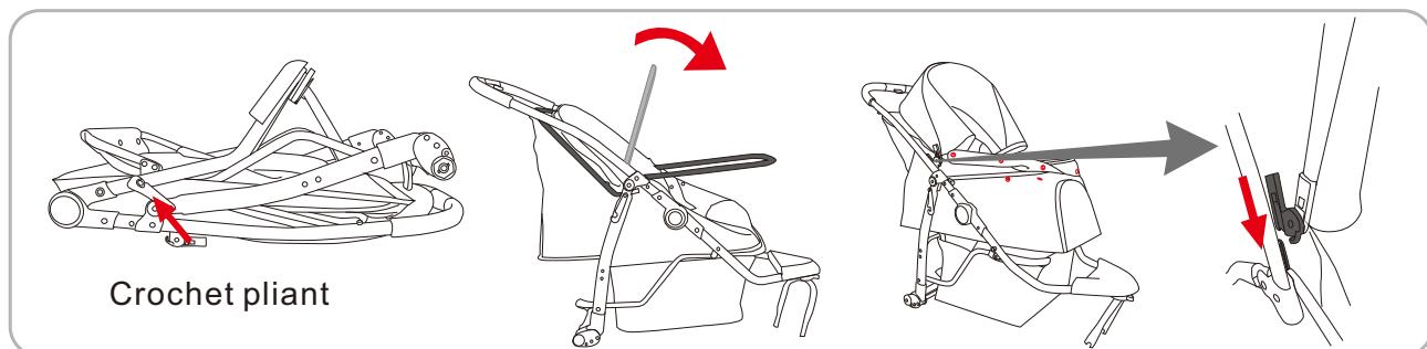
1. déplier le cadreDétachez le crochet, tenez le guidon à deux mains et soulevez-le jusqu'à ce qu'un clic se fasse entendre, ce qui signifie que le cadre est complètement ouvert. Après avoir ouvert le cadre, retournez le tube de la barre de capotage vers l'avant, puis fixez la boucle à l'avant et insérez la bande dans le bouton. Dépliez la voile et refermez-la.
