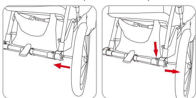
4.Installation et démontage des roues arrière Comme indiqué sur l'image, placez la roue arrière dans le trou du siège de la roue arrière, entendez le "clic". Maintenir le bouton d'extraction et le tirer vers l'extérieur.la roue arrière peut être retirée.
