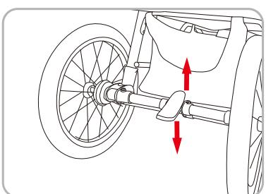
5. Uso della leva del freno della ruota posteriore
