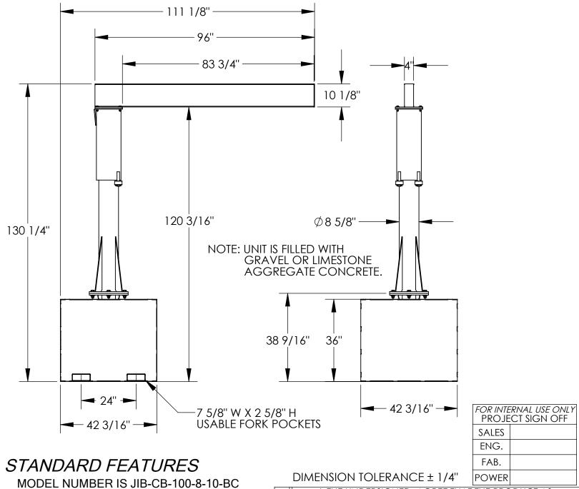
CAPACITY IS 1.000 LBS OVERALL WIDTH IS 42 3/16" **USABLE WIDTH IS 4"** OVERALL I-BEAM LENGTH IS 96" USABLE I-BEAM LENGTH IS 83 3/4" OVERALL HEIGHT IS 130 1/4" UNDER I-BEAM HEIGHT IS 120 3/16" BASE HEIGHT IS 36" I-BEAM SIZE IS: 10 1/8" HEIGHT X 4" FLANGE WIDTH FORK CENTERS IS 24" **USABLE FORK POCKETS IS:** 7 5/8" W X 2 5/8" H
