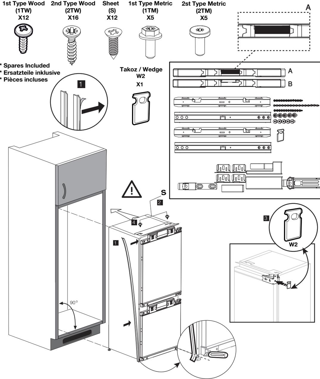
**Not:** 2-3 numara ile gösterilen montaj adımımda üst bağlantı plastiğini kaydırabilmek için bağlantının yapıldığı vidaları tam sıkmayınız.
