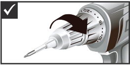
Power Tools: Set to Low Torque / Herramientas eléctricas: Establecer a baja velocidad
