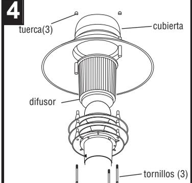
Poner el difusor en la base y adherir la cubierta con tornillos y tuercas.
