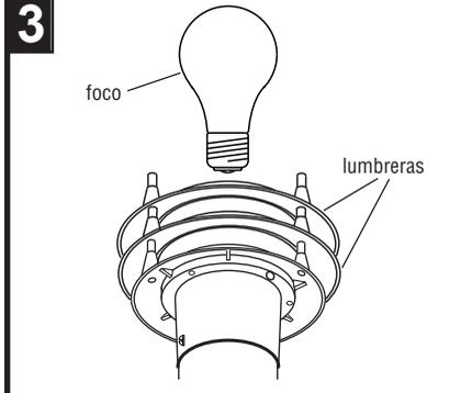
Colocar lunbreras a base. Instalar foco en casquillo. Asegurarse de que el foco no sea de una potencia de vatios más alta que lo especificado para este dispositivo.
