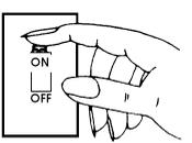
Coloque el interruptor en apagado. (Si la instalacion tiene un interruptor integrado o de cadena, asegurarse que este apagado).
