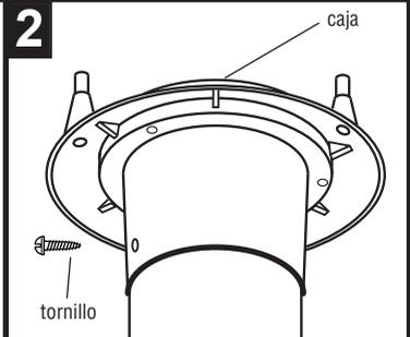
Colocar el dispositivo sobre el poste de acuerdo a la ilustración. Sujetar con el tornillo en el agujero del cuello del poste, taladrando un agujero a la misma altura a través del poste y asegurar con tornillos.
