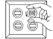
Fusibles desatornillables. Desatornille los fusibles que controlan la electricidad en el cuarto que va a trabajar.
