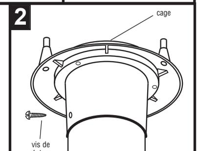
Placer l'appareil sur la borne comme ci-dessus. Visser dans les trous du col de la borne en perçant des trous au même endroit que dans la borne et fixer avec des vis.
