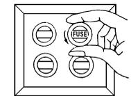
Dans le cas des fusibles pouvant être vissés, dévisser le ou les fusibles qui contrôle(nt) l'alimentation à l'appareil d'éclairage ou à la pièce dans laquelle l'installation a lieu.
