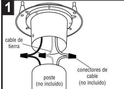
Conectar los cables. Nota: Unir cable negro del artefacto al cable negro de la caja de corriente, cable blanco del dispositivo al cable blanco de la caja de corriente. No mezclarlos. Utilizar conectores de cable (no incluidos). Conectar el cable descubierto de tierra del dispositivo con el cable de la caja. NUNCA CONECTAR CABLE DE TIERRA A CABLE NEGRO O BLANCO.
