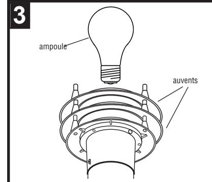
Placer les auvents sur le culot. Installer l'ampoule dans la douille. S'assurer de ne pas excéder la puissance en watts indiqué sur l'appareil d'éclairage.
