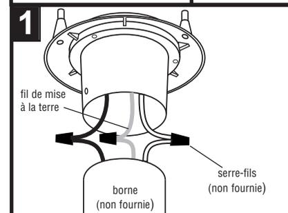
Raccorder les fils. Note: attacher les fils noirs de l'appareil au fil noir d'alimentation et les fils blancs de l'appareil au fil blanc d'alimentation. Ne pas les mêler. Utiliser les serre-fils (non fournis). Fixer les fils de mise à la terre au fil d'alimentation de mise à la terre. NE JAMAIS RACCORDER LE FIL D'ALIMENTATION DE MISE A LA TERRE AVEC LES FILS BLANC OU NOIR D'ALIMENTATION.
