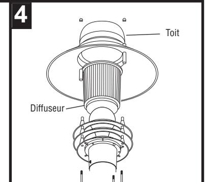
Placer le diffuseur dans le culot, attacher le toit.
