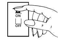
Eteindre l'appareil d'éclairage! (Placer l'interrupteur mural en position "off", si l'appareil d'éclairage est pourvu d'un commutateur incorporé ou d'une chaînette, éteindre ou tirer la chaînette pour que l'appareil soit éteint).
