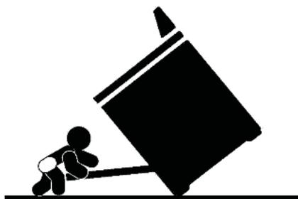
Pour réduire le risque de basculement de l'appareil, celui-ci doit être fixé au moyen de dispositifs anti-basculement, conformément aux instructions d'installation. Remettre en place les dispositifs anti-basculement après tout déplacement de la cuisinière.
