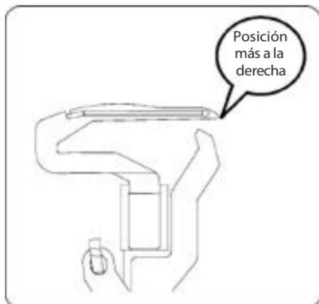
Nota: Utilice las pinzas de la caja de accesorios para facilitar el enhebrado.
