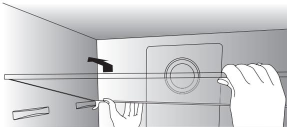
2. Para volver a instalar un estante, colóquelo en los soportes frontales y traseros. Empuje el estante hacia la parte trasera del refrigerador hasta la parte posterior de los ganchos del estante alrededor de los soportes del estante trasero.
