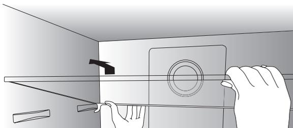
2. Pour réinstaller une tablette, faire reposer la tablette sur les supports avant et arrière. Pousser la tablette vers l'arrière du réfrigérateur jusqu'à ce que l'arrière de la tablette s'accroche aux supports arrière de la tablette.
