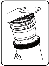
2. 按压吹粉硅胶, 将机器内残留的咖啡粉末吹出。
