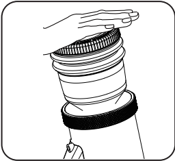
步骤 3 将手放置在豆杯盖上方，轻轻 按压豆杯盖，将机器内部残留 的咖啡粉末吹出机器。
