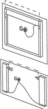
**ITA - Prendere le misure dell'interasse tra i fori sullo specchio ed eseguire i fori con una punta di 6mm di diametro.**
